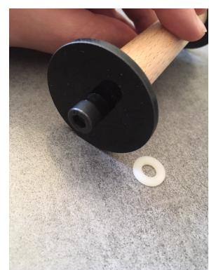
Un côté de la bobine est trop large pour entrer dans l'instrument : il est possible de remettre en place correctement la petite bague en plastique en dévissant légèrement la vis.
